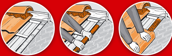
Bevestigen van gevelpannen
