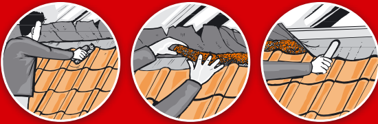
Afdichten van loodaansluitingen
