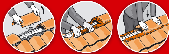
Bevestigen van nokvorsten en hoekkepers
